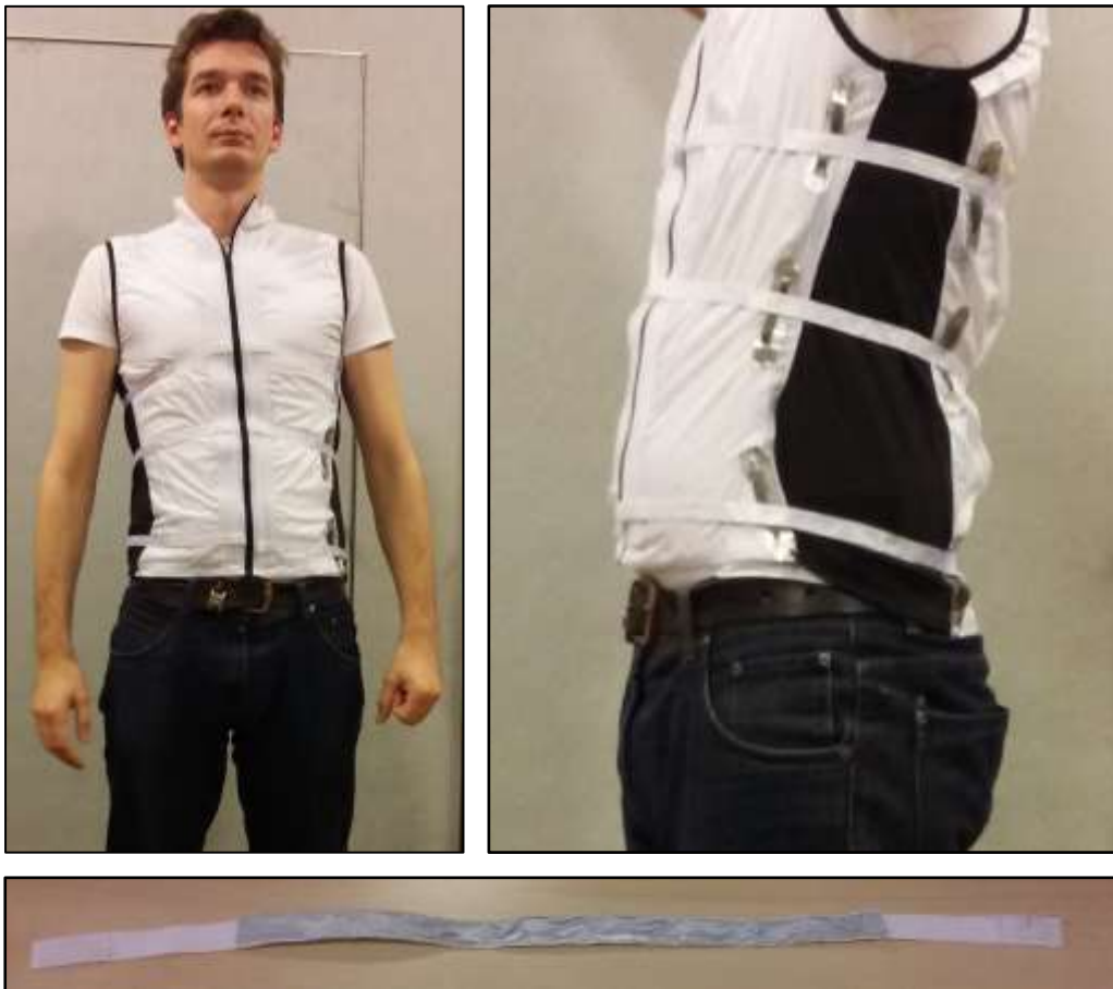
Fig. 8: Het vervaardigde prototype: LB : vooraanzicht, RB : Zijaanzicht met geleidende connectoren, Onder : Losse band met geleidende middenstuk en elastische uiteinden.
