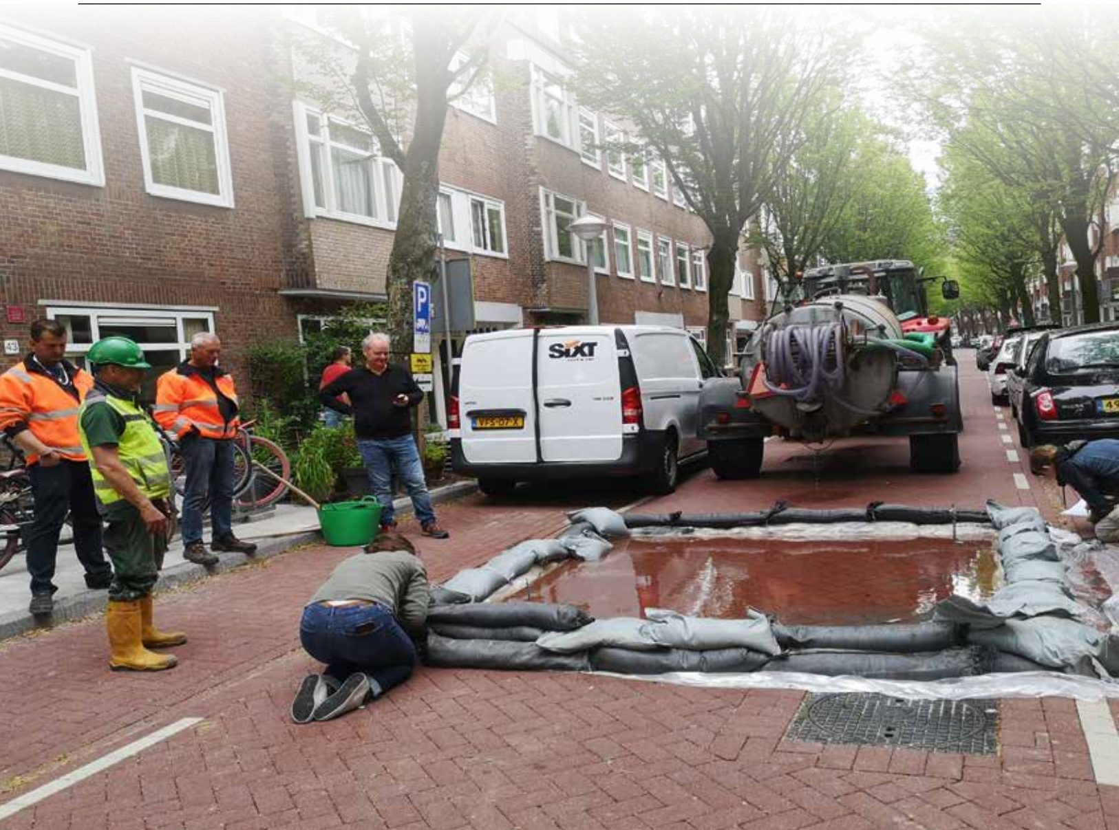
Proef met waterdoorlatende verharding in de Kromme Mijdrechtstraat in Amsterdam.
